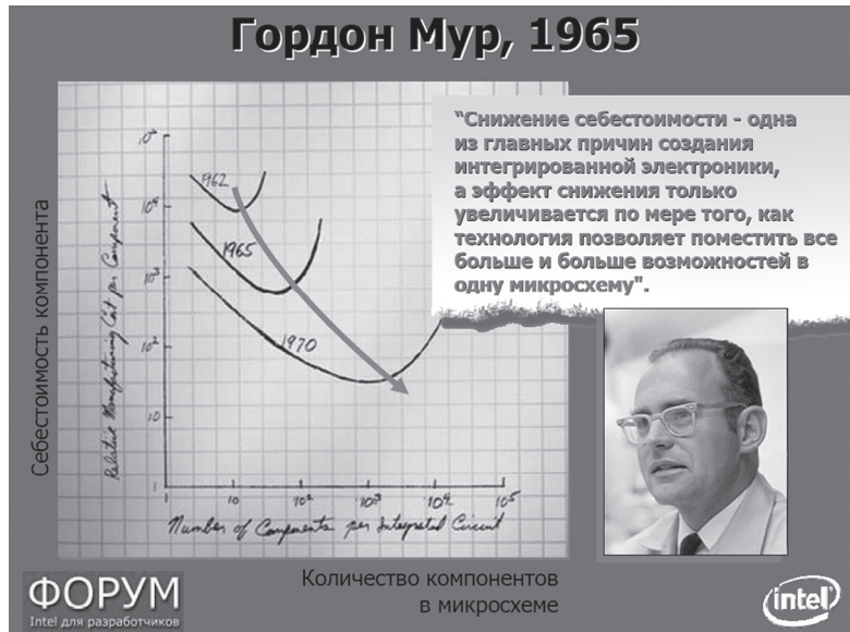
Рис. 5. Динамика снижения стоимости микросхем с ростом количества компонентов в микросхеме
