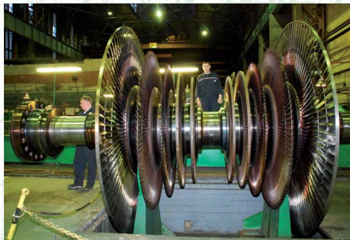
Ротор турбины для Экибастузской ГРЭС в Казахстане.
