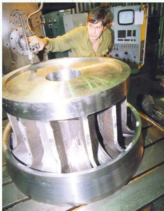
Агрегаты от «Силовых машин»: генератор для Бурейской ГЭС; колесо для Бадахшанская ГЭС.
