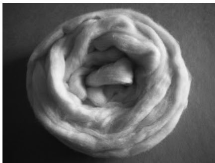
Рис. 3. Хлопок товарной позиции 5203: хлопок, подвергнутый кардо- или гребнечесанию, ровница (cotton roving) [10]
