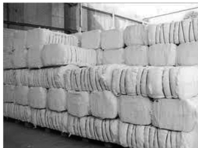
Рис. 1. Хлопок товарной позиции 5201: кипы хлопкового волокна, не подвергнутого кардо- или гребнечесанию. Упаковка: стандартная экспортная упаковка в кипы. Масса: 165 \pm 5 кг на кипу [9]
