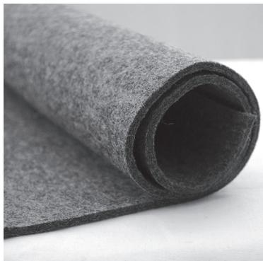
Рис. 2. Пример войлока, полученного иглопробиванием, совмещенным с термоскреплением
