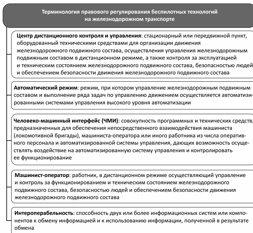
Рис. 2. Терминология ГОСТ Р 70059-2022 в сфере беспилотных железнодорожных технологий
